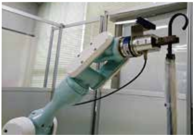
距離センサーとカメラの情報で制御するロボットアーム
