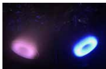
抗菌コーティング装置内部のプラズマによる固体原料の分解の様子(右:炭素、左:銅)
